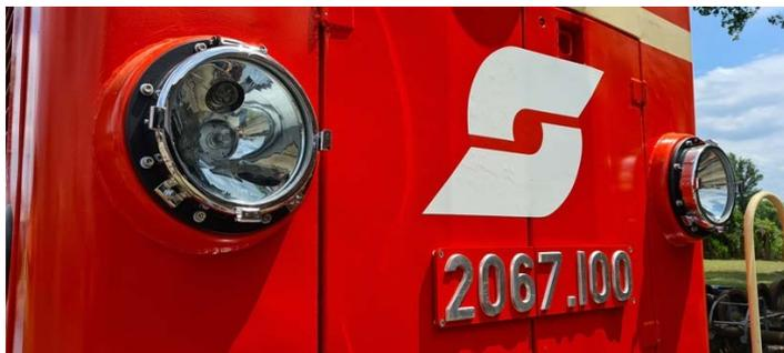
Nachdem sich die zweiachsigen Dieselloks der Reihen 2060 und 2062 für viele Aufgaben als zu schwach erwiesen, wurde von der Firma SGP die 600 PS starke, dreiachsige Baureihe 2067 entwickelt. Der Motor basiert auf dem Viertakt-Zwölfzylinder vom Typ SGP S12a. Die Kraftübertragung erfolgt über ein hydraulisches Voith-Getriebe (Typ L28St) auf eine Blindwelle die durch Stangenantrieb mit den drei Achsen verbunden war. Von 1959 bis 1977 wurden insgesamt 111 Lokomotiven von den ÖBB übernommen.
